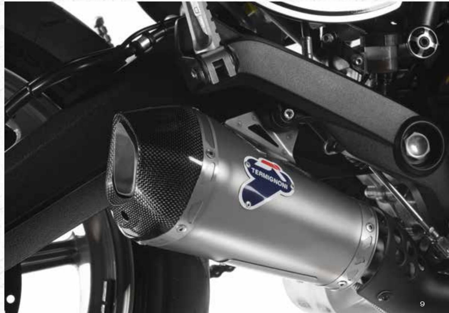
Gruppo di scarico completo in acciaio Race-Line. Prodotto da Termignoni; i collettori 2-1 in posizione rialzata ed il silenziatore racing con Db-killer removibile sono un chiaro richiamo estetico alle gare di regolarità e di flat-track. Le performance fluidodinamiche e la mappatura dedicata, installabile grazie alla chiavetta up-map in dotazione, ne costituiscono l'essenza.
